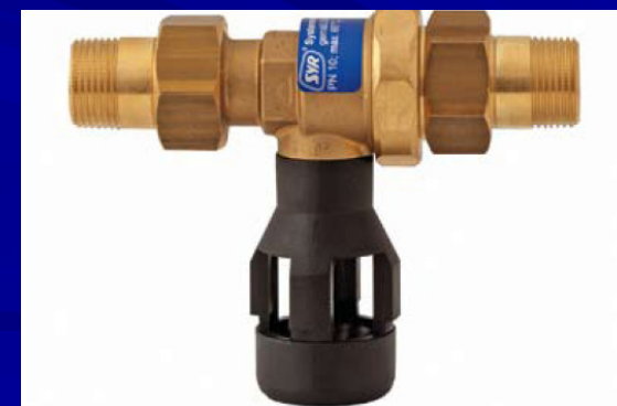
■ Bild 2: SYR Systemtrenner Typ CA: Diese für Deutschland neue Armatur wurde in die DIN EN 1717 aufgenommen und ist für Anwendungen bis zur Flüssigkeitskategorie 3 einsetzbar.
